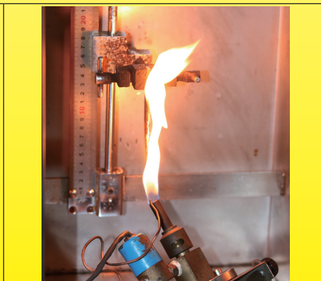
Образец во время испытания на UL94VO
