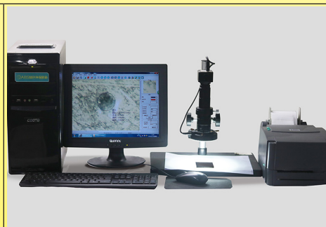
Измерение диаметра выемки с помощью электронного микроскопа (лаборатория Ultimheat)
